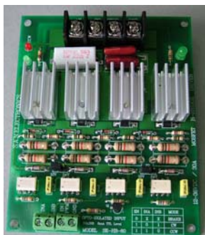
รูปที่ 4 บอร์ดขับมอเตอร์ดีซีแบบ H-Bridge 30 A
