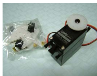
รูปที่ 5 เซอร์โวมอเตอร์ขนาดเล็กสำเร็จรูป
