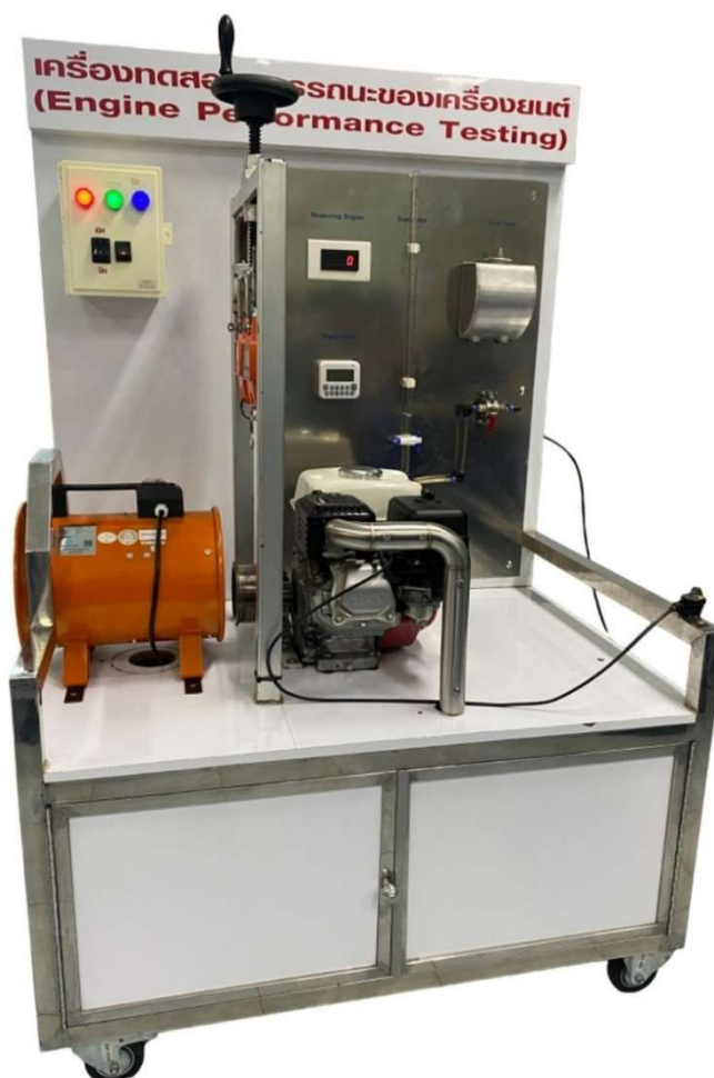
ภาพที่ 1.10 แสดงเครื่องทดสอบการวัดอัตราการสิ้นเปลืองน้ำมันเชื้อเพลิง ที่มา : ไพศาล พรณฤชิตพงศ์ (2566)
