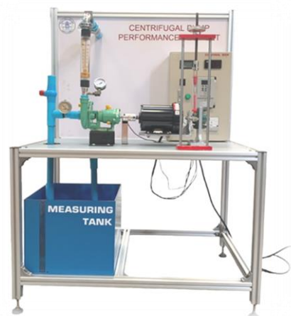
หน่วยที่ 2 เครื่องสูบน้ำแบบหอยโข่ง (Centrifugal Pump)
